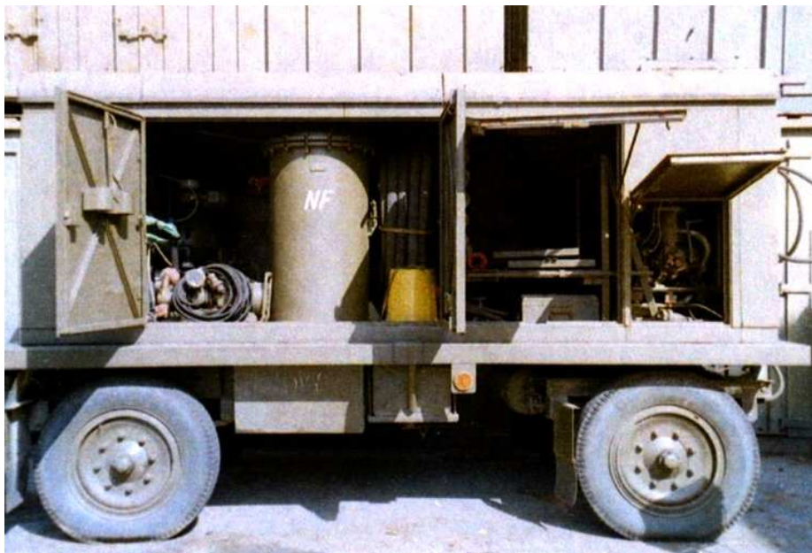
Úpravna vody 2000 l/h.
